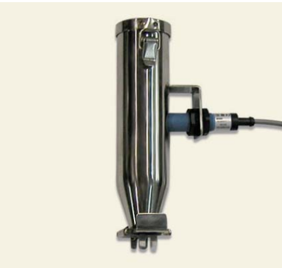
Mini hopper for Micro-1 Capacity : 500ml
